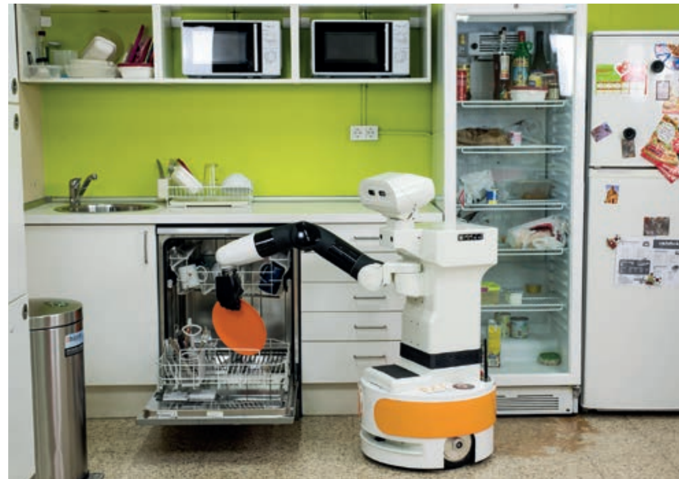
Taiga van het Spaanse PAL Robotics haalt een bord uit een vaatwasser. Deze robot dient als basis voor de nieuwe uitvoering van zorgrobot Rose, die vergelijkbare klusjes gaat doen.
