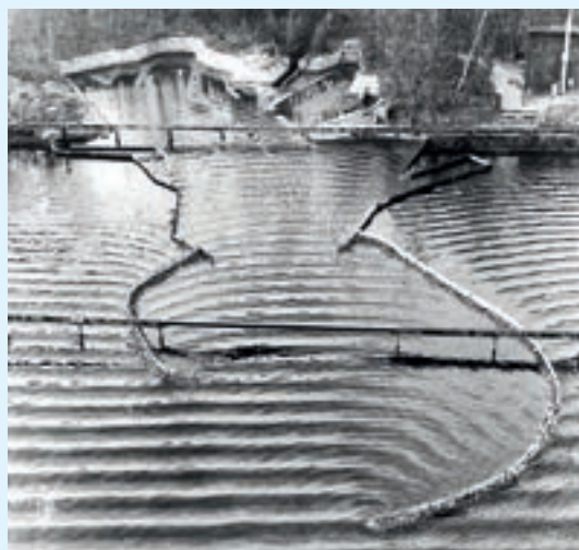
Een proefmodel van de pieren bij IJmuiden op het terrein van het Waterloopkundig Laboratorium.
