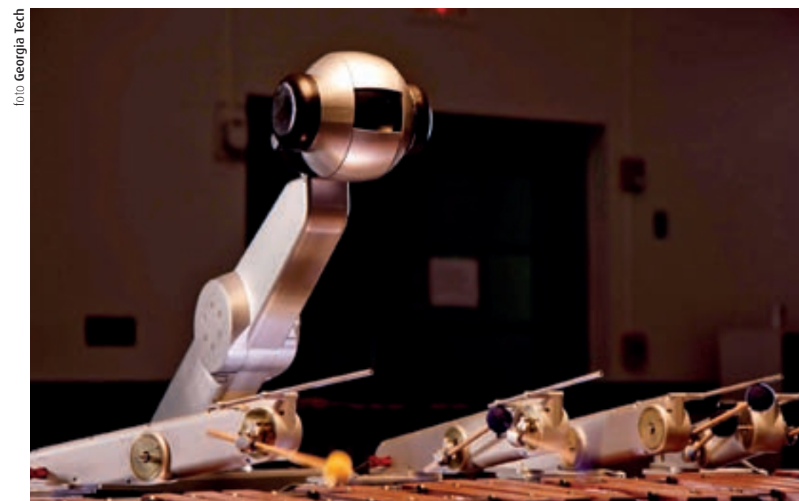
Deze robot bespeelt een marimba en bedenkt intussen zijn eigen melodieën. De stokjes houdt hij met vier handen vast.
