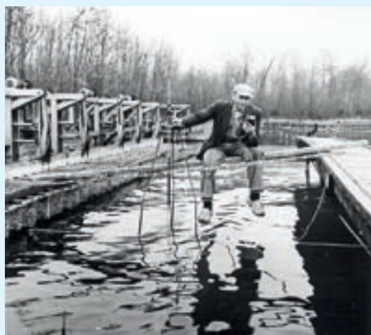
Een medewerker van het Waterloopkundig Laboratorium meet golfhoogtes in een model van de Deense Thyborøn-haven.
