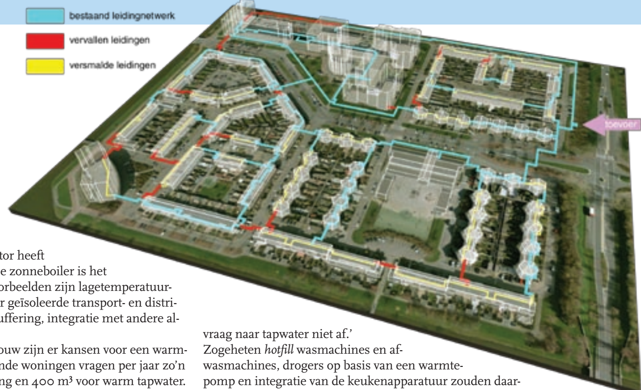
Opwaardering van het warmtenet rond de Persijnlaan in Purmerend: het ringleidingensysteem wordt doorbroken en een groot deel van de leidingen wordt vervangen door dünnere exemplaren.
