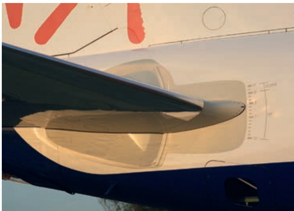
Het stabilo van een Embraer ERJ-170. De woorden 'up' en 'down' slaan op de richting van de neus van het vliegtuig ten gevolge van de oriëntatie van het stabilo.
