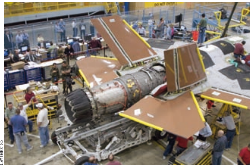
Plaatsing van de F135-motor in de F-35 AA-1.
