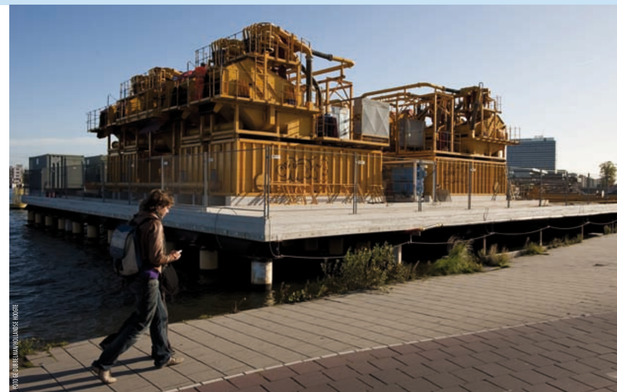
Achter Amsterdam Centraal staat de scheidingsinstallatie van de boormachine.
