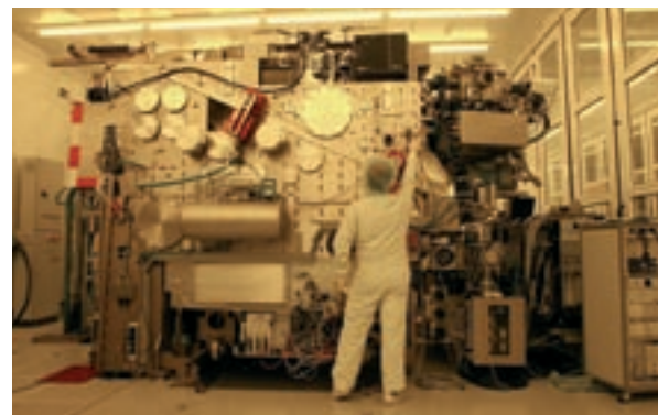
De EUV-machine in aanbouw in de ontwikkel-cleanroom van ASML. De foto heeft hetzelfde aanzicht als de computertekening.
