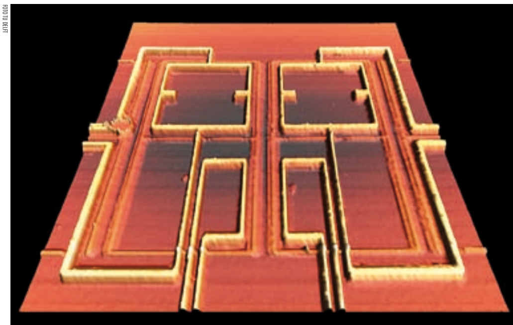
Een logische poort bestaande uit twee fluxqubits (links en rechts op de afbeelding), gemaakt met een atomic force microscoop.
