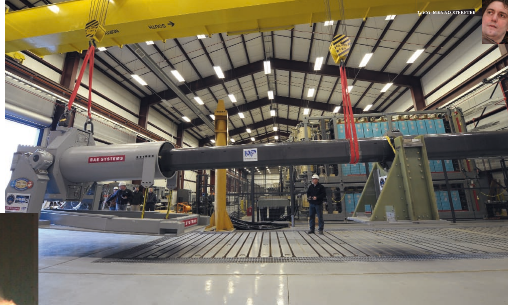
Het prototype van de railgun van BAE Systems heeft een mondingssnelheid van ruim 9000 km/h. Rechts zijn de condensatoren voor de stroomvoorziening zichtbaar.
